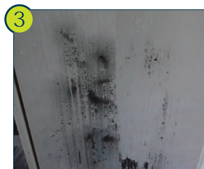
ハンドポンプで霧状の水を発生させ、壁面を湿らせた。右半分はコーティングによる親水効果が確認できた。
